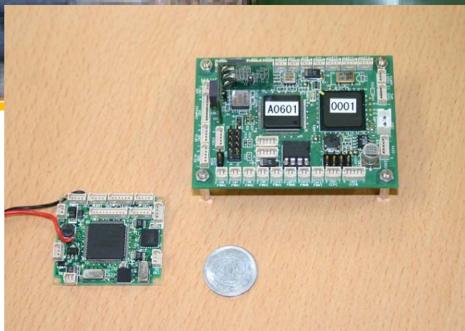
小型軽量自律飛行制御基板 MAVCxシリーズ
